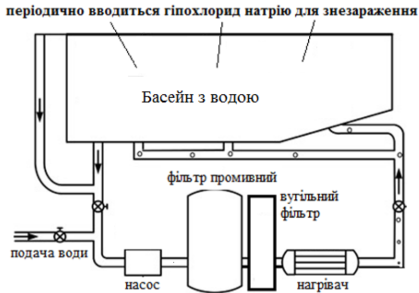
Рис. 2.4 - Типова схема електротехнічного комплексу водопідготовки води для басейнів з використанням гіпохлориду натрію
